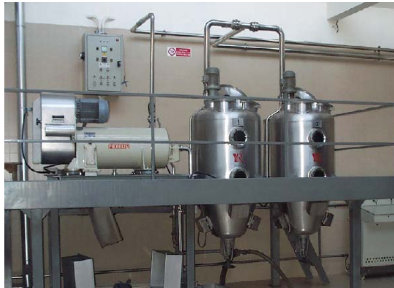
Semi-continu en 2 cuves de 500 L (Reus - www.etsreus.com )
